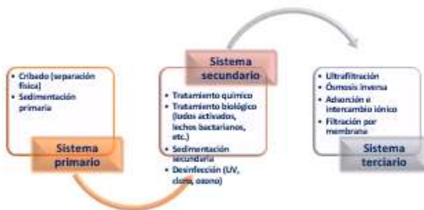
Figura 2. Diferentes procesos unitarios que conforman los procesos de depuración de aguas residuales (Howe et al. , 2012).
