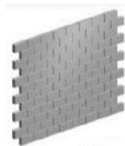
Figura 1. Mampostería simple (no reforzada) (Zalamea Suárez, 2015).
